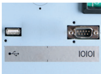
Ports de communication RS 232 et USB host
