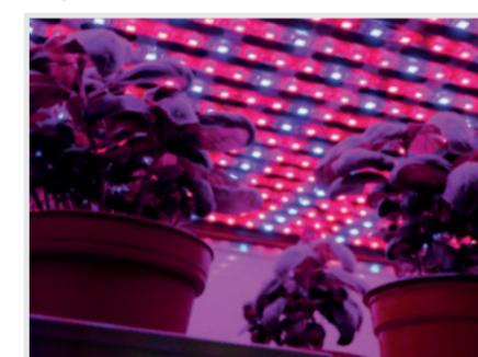
Cámara de crecimiento optimiza la alta intensidad de iluminación con el espectro óptimo de la fuente LED para la fotosíntesis con el consumo bajo de la energía.
